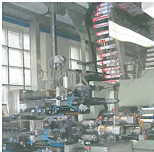
Mit bis zu sechs Farben können die Tuben bedruckt werden.
