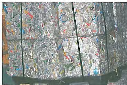
Zu Blöcken gepresst wartet das Alu-Recyclat auf die Fahrt in die Schmelze.
